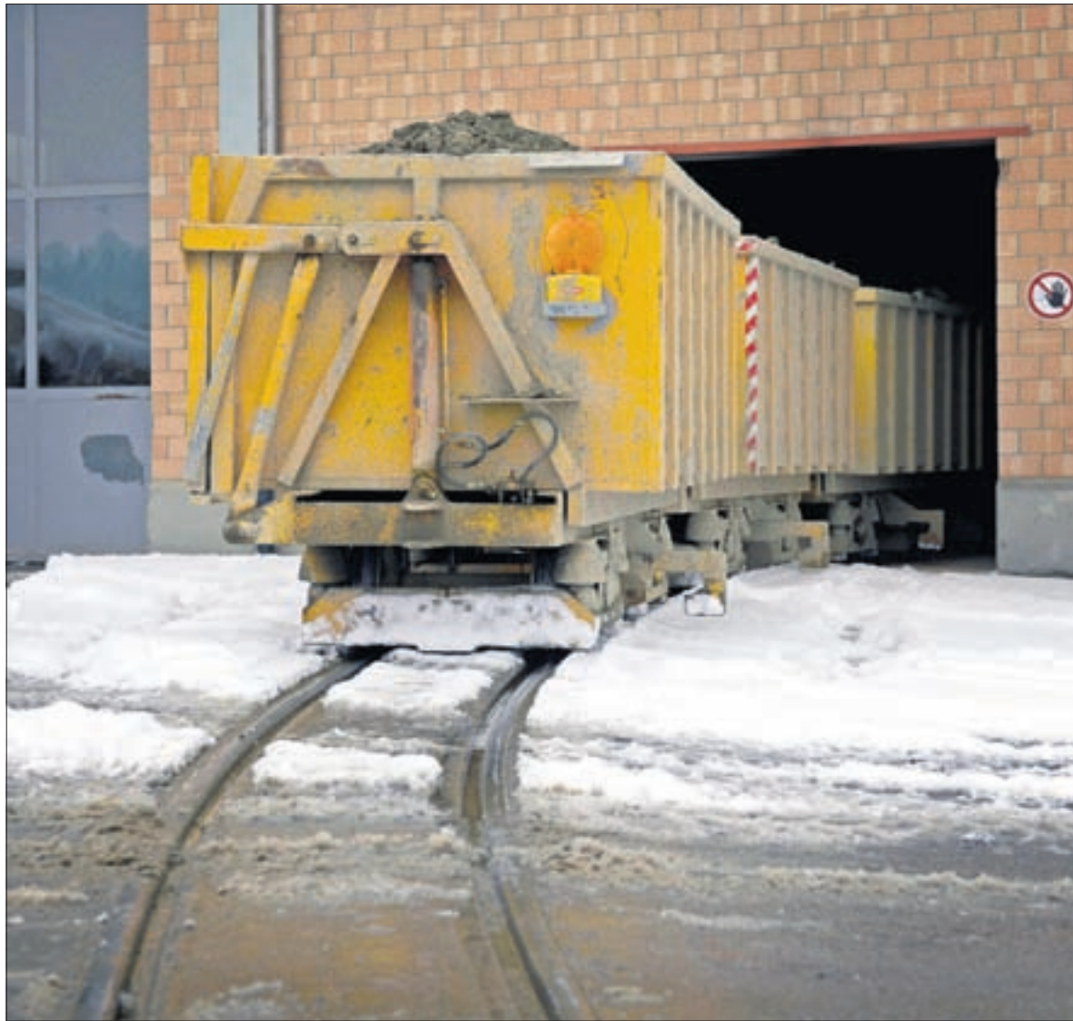
Mit dieser über hundertjährigen Feldbahn wird das Rohmaterial – der Ton – von der nahen Lehmgrube in Kurt Schumachers Fabrik gekarrt.
